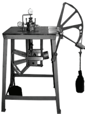
Рис. 4.3. Прилад для визначення міцнісних характеристик сумішей
